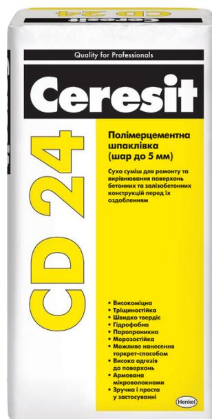
мішати. Приготовану розчинову суміш необхідно використати протягом 30 хвилин. Розчинову суміш за допомогою металевого шпателя нанести на вологу основу та рівномірно розподілити по поверхні конструкції. Розчинову суміш Ceresit CD 24 можна наносити способом торкретування. Надлишок розчинової суміші видалити, інструменти очистити та промити водою. Затверділий розчин можна видалити тільки механічним способом.
