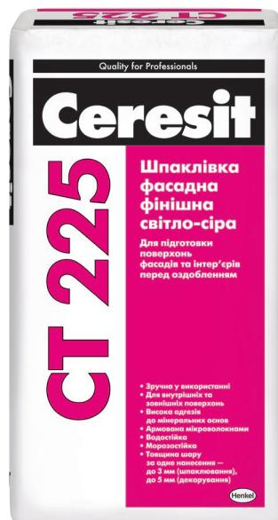
номірним суцільним шаром товщиною не більше ніж 3 мм за одне нанесення. Для влаштування декоративного шару нанесення виконують аналогічно, максимальна товщина шару при декоруванні – не більше ніж 5 мм. Структуру формують за допомогою структурних валиків, шпателя або терки. За температури +20 ± 2 °C і відносної вологості повітря 55 ± 5% шліфування (за необхідності) можна розпочати через 24 години, а фарбування чи нанесення декоративних водно-дисперсійних штукатурок – через 72 години.
